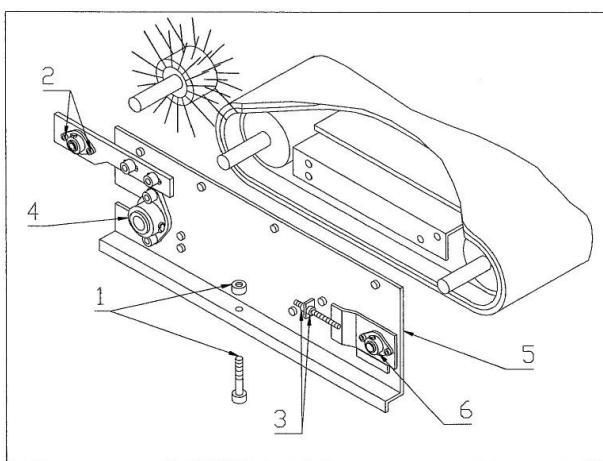
Монтаж и удаление ленты конвейера
