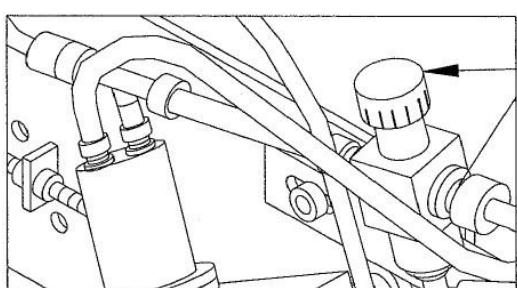
**! Регулятор скорости конвейера:**
