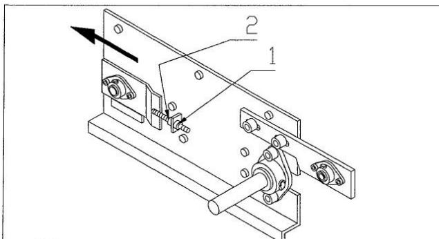
Протяжка конвейера (в случае скольжения) - ослабляют контргайку (1).
