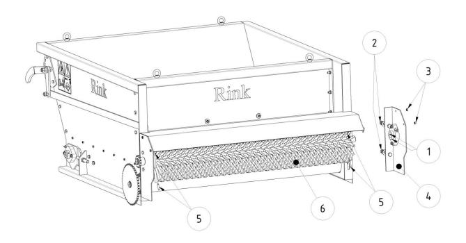
Il rullo a spazzola (6) consiste di 10 segmenti singoli, che sono tra loro interconnessi. Entrambi i segmenti esterni sono assicurati sull'albero, ognuno con tre viti senza testa (5). Per sostituire il rullo a spazzola procedere come segue:
