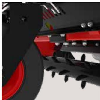
Dispone de una trampilla de control ajustable para permitir que el material fluya por encima o sea transportado con la máquina.
