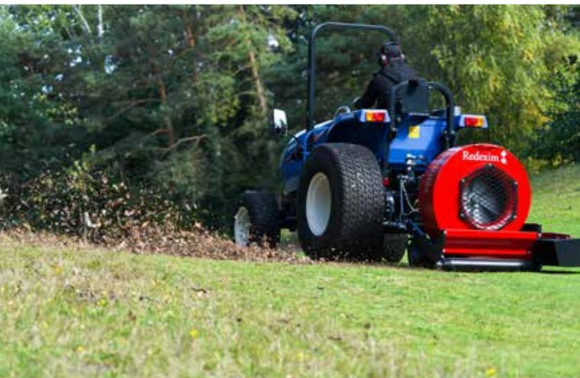
Potente pero ligera, la Verti-Air<sup>®</sup> 7 solo requiere una potencia de TDF de 30 hp y está diseñada para tractores compactos. Cuenta con un boquilla inversa ajustable, controlada desde el asiento del operador, para cambiar sin esfuerzo la dirección del flujo de aire. Las ruedas grandes y el rodillo antidesbroce garantizan un rendimiento duradero.
