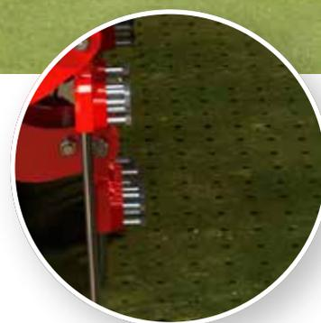
Todas las máquinas Verti-Drain tienen la capacidad de oscilación. Esta parte crucial del proceso de aireación levanta el suelo para acabar con la compactación y crear espacio para las raíces de la planta.
