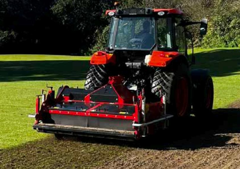
La Multivator funciona con el rodillo trasero dentro o fuera del suelo, dependiendo de los requisitos de la cobertura y del grado de ondulación.
