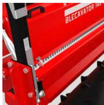
Barra niveladora para crear un acabado liso y nivelado.
