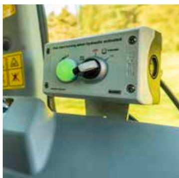
Control de flujo hidráulico analógico permite manejar el esparcidor desde el asiento del tractor.
