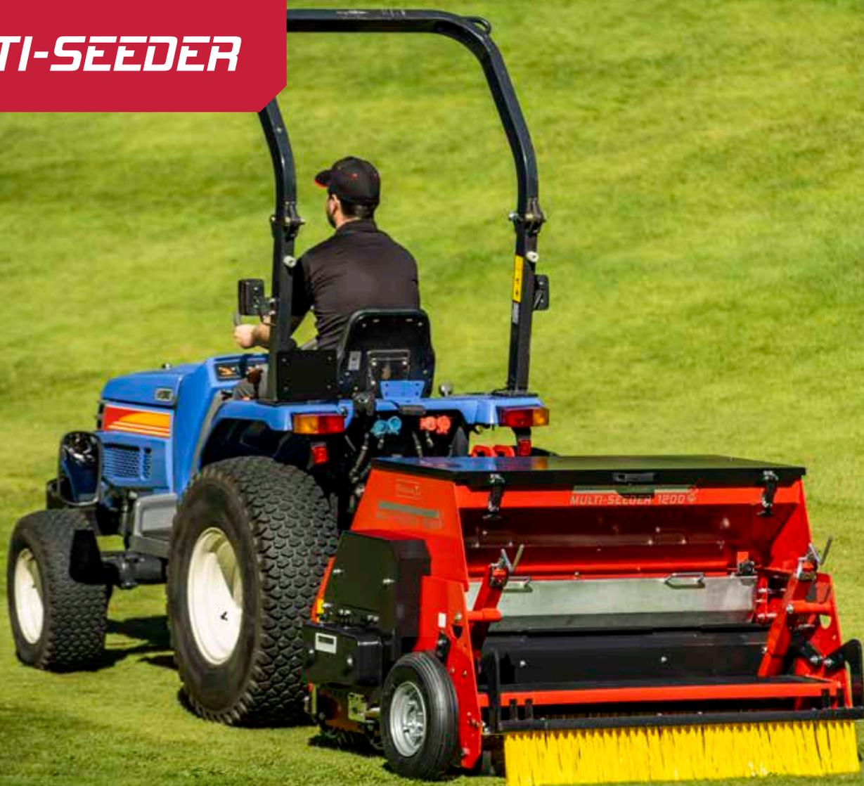
La Multi-Seeder funciona en diferentes tipos de césped y de superficies gracias a su sistema de siembra adaptable y a su soporte de rodillo flotante.
