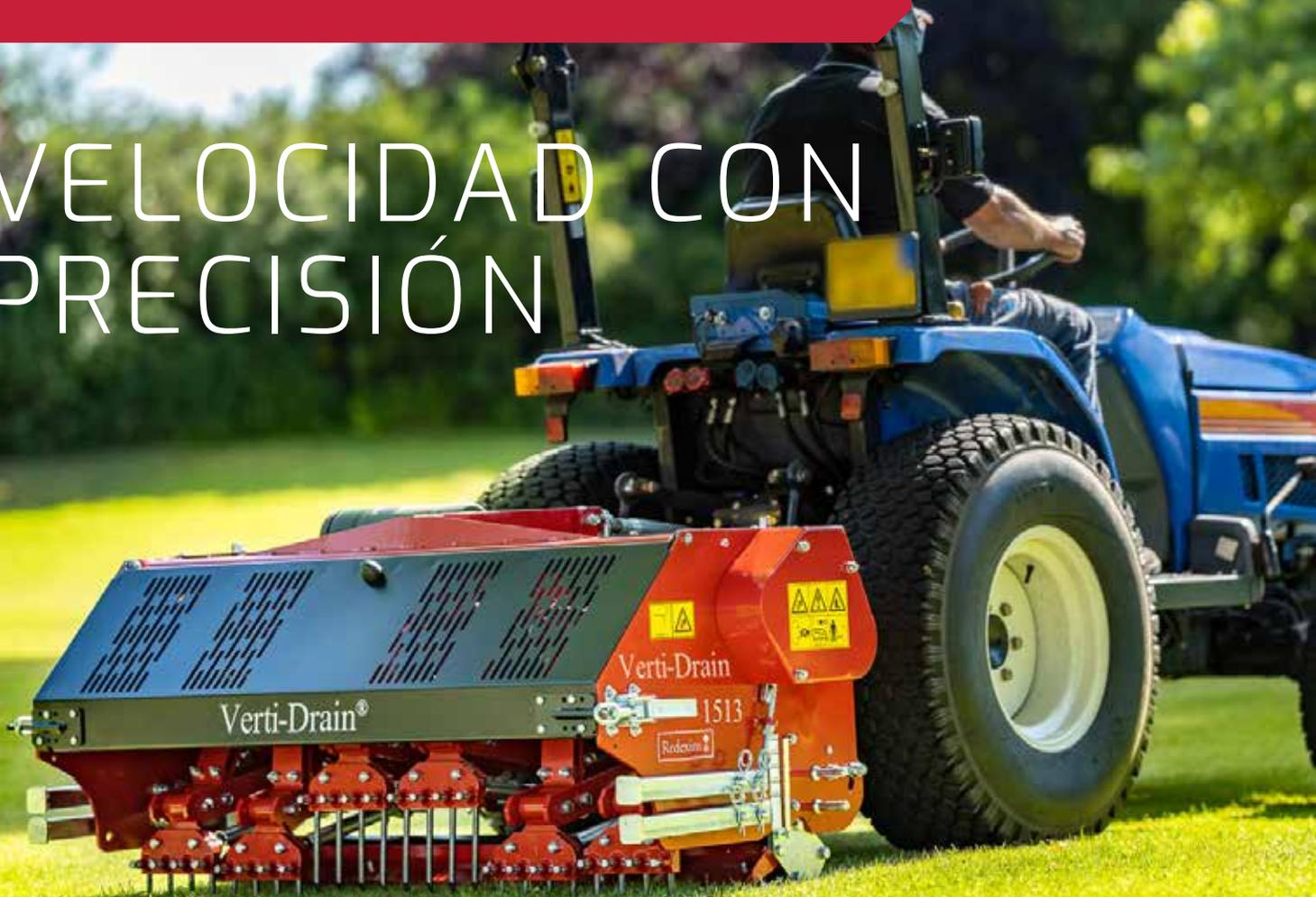
Las ligeras Verti-Drain® 1513 y 1517 pueden trabajar hasta una profundidad de 150 mm (6") y son muy adecuadas para superficies de césped delicadas. La máquina accionada por correa funciona a alta velocidad y ofrece un patrón de orificios limpio y uniforme. Se puede añadir un rodillo trasero opcional para alisar la superficie y dejar un acabado impecable.
