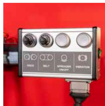
El sistema de control PotiPro permite cambiar la anchura y el grosor de esparcido sobre la marcha.
